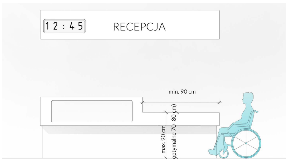
Rys. 45 Wytyczne dotyczące dostępności lad recepcyjnych, itp.
