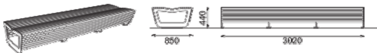
Ryc. 19: przykładowa forma szerokiego profilowanego siedziska z drewnianych elementów oraz jej wymiary charakterystyczne
