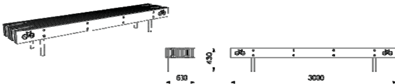
Ryc. 17: przykładowe ławka ze stojakiem rowerowym oraz jej wymiary charakterystyczne
