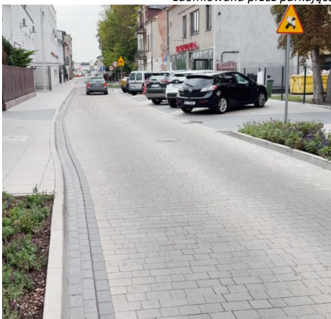
Ulica wyprowadzająca ruch z Placu 3 Maja od strony północnej – ul. Mickiewicza - wprowadzone zawężenie, ograniczenie prędkości i środki uspokojenia ruchu na ulicy, co ocenić należy pozytywnie.
