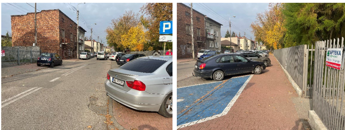
Ulica Prądyńskiego – organizacja ruchu wskazuje na możliwość parkowania ukośnego (w zatoce do parkowania równoległego) przez co zdarza się znaczne ograniczenie chodnika
