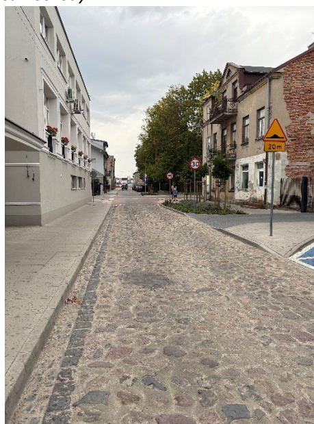
Ulica wyprowadzająca ruch z Placu 3 Maja od strony północnej – ul. Mickiewicza - wprowadzone zawężenie, ograniczenie prędkości i środki uspokojenia ruchu na ulicy, co ocenić należy pozytywnie.
