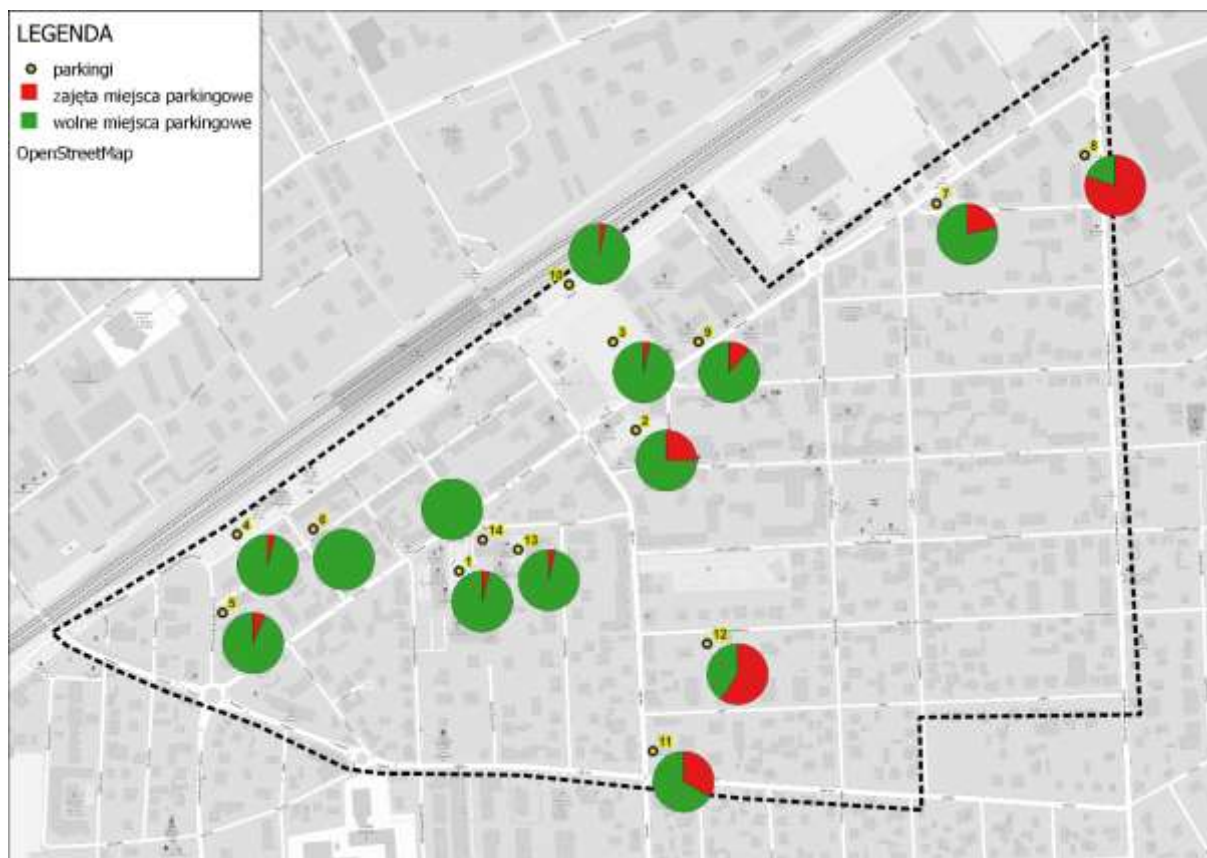
Rys. 4.18. Wykorzystanie parkingów w porze nocnej.
